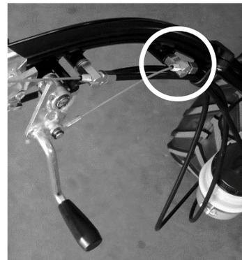
In Fig. a sinistra è mostrato il registro del cavo per la trazione alle ruote. In Fig. a destra è mostrato il registro del cavo per l'innesto rotore. Per interventi più specifici rivolgersi a una officina autorizzata.
