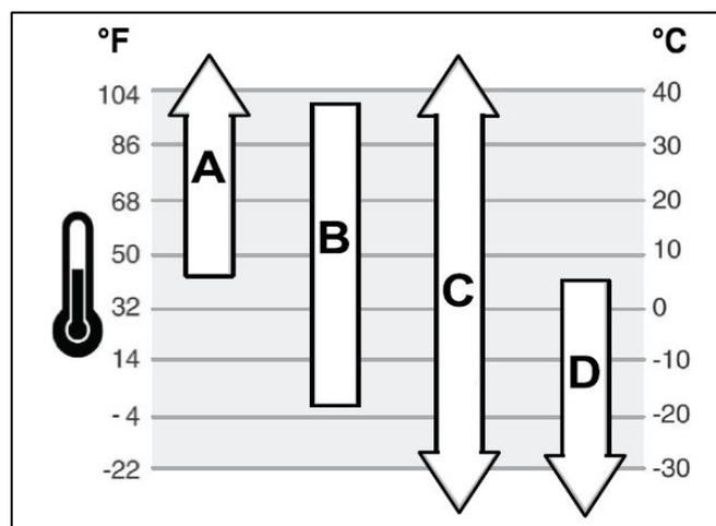
**TIPOLOGIA DI OLIO MOTORE:** Sono le temperature esterne a determinare la corretta viscosità dell'olio per il motore. Usare i riferimenti di seguito per selezionare la migliore tipologia in base alle temperature di lavoro.
