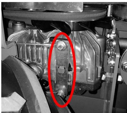
La leva direzione di marcia agisce sulla trasmissione idrostatica tramite una coppia di cavi la cui tensione può essere registrata al bisogno tramite i registri indicati in figura a lato (destra).
