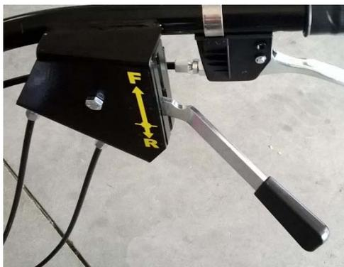
– **DIREZIONE DI MARCIA:** la leva direzione di marcia [#4 in **Cap 6a**] è quella responsabile della direzione e della velocità degli spostamenti a patto che la leva trazione alle ruote [#1 in **Cap 6a**] sia premuta. Portarla verso l'alto (F) per andare da fermo alla massima velocità in avanti oppure verso il basso (R) per andare in retromarcia (come indicato dai simboli). La posizione centrale è quella in cui le ruote risultano ferme.
