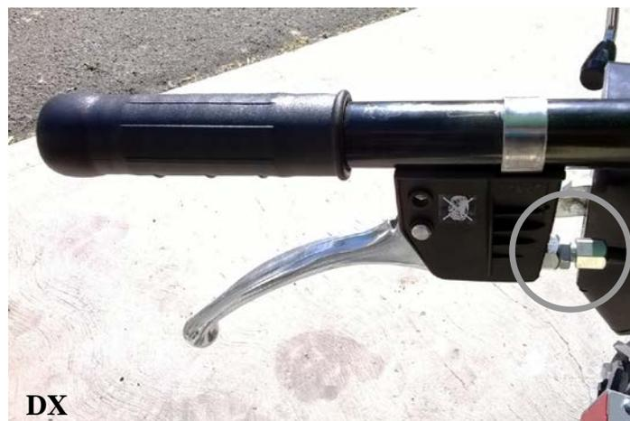
È possibile intervenire sulla regolazione delle leve di sbloccaggio del differenziale tramite gli appositi registri indicati nelle due figure sopra (rispettivamente lato SX e DX delle stegole di guida).
