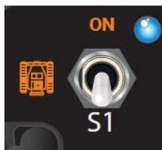
2) Per sbloccare il freno e dare il consenso al movimento dei cingoli azionare l'interruttore S1 sul radiocomando. L'accensione del LED posto a fianco indica che il freno è disinserito e si può procedere con la guida. Viceversa per azionare il freno di stazionamento, specialmente per sostare in pendenza, azionare di nuovo l'interruttore S1 e il LED blu (E) si spegnerà.
