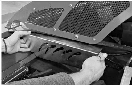
1) Rimuovere la copertura dell'elettromagnete tirandola a mano verso l'esterno.
