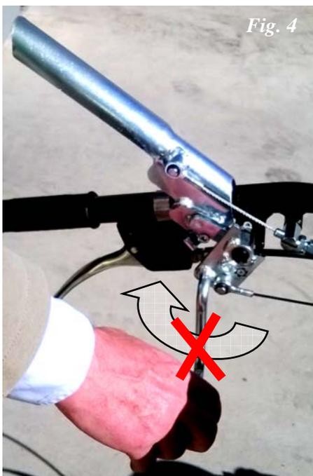
La falciatrice RF 710 è dotata di un BLOCCO MECCANICO DI SICUREZZA che impedisce l'azionamento della leva "B" (indicata in **Fig. 2/3**) se prima non è stata innestata la leva "A" (**Fig. 3**). L'azionamento esclusivo della leva "B", come tentato in **Fig. 4**, non è possibile.
