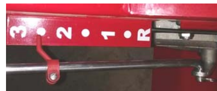
Fig. 3 Esempio di asta comando marce in posizione di folle (per RL 408/428; RL 426 ha 2 marce avanti + retro)
