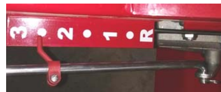
Fig. 3 Esempio di asta comando marce in posizione di folle (per RL 408/428; RL 426 ha 2 marce avanti + retro)
